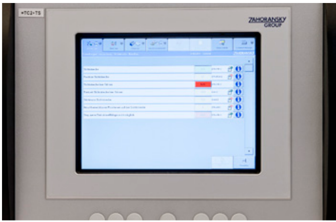
Ermöglicht eine komfortable und intuitive Bedienung: Das 15-Zoll-Touchdisplay verfügt über ein robust ausgelegtes Infrarot-Touchdisplay mit Sicherheitsglasstechnik.
